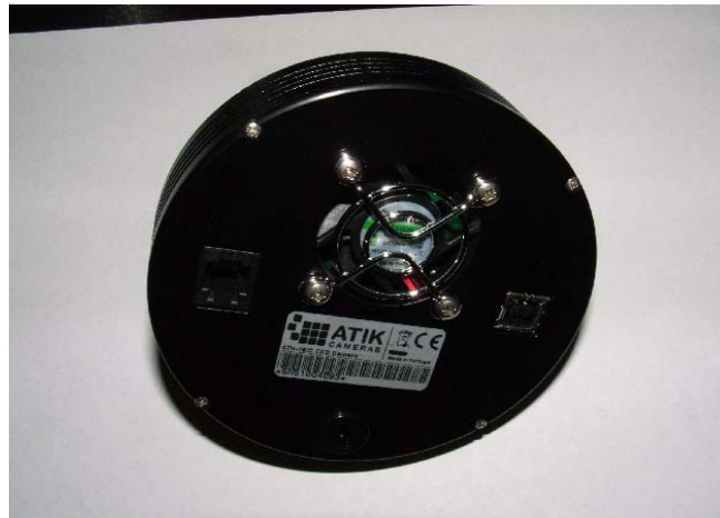
Abb. 3: CCD-Kamera: ATIK 16-IC, Chipgröße 6mm diagonal, Pixelgröße 7,4 \mu\text{m} quadratisch, horizontale Pixelanzahl 659, vertikale Pixelzahl 494.
